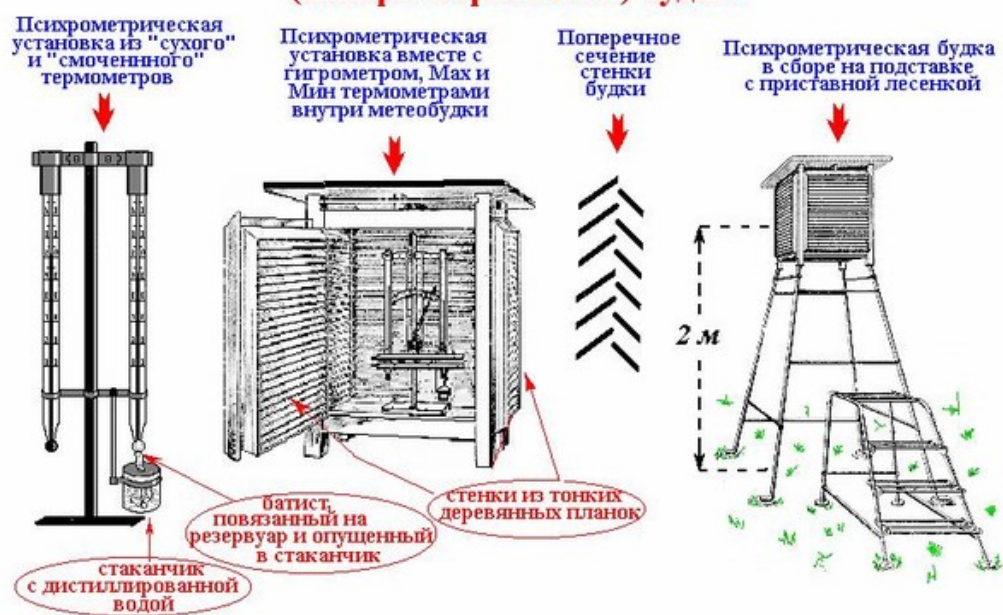
Рис. 3. Психрометрическая будка (общий вид)
